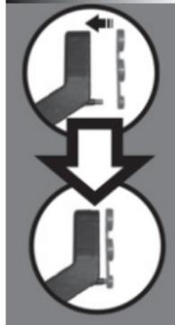
Encaixe o fixador na haste lateral conforme sequência da **Figura 01**. Posicione o conjunto no quadro (**Figura 02**). Insira os parafusos flangeados e aperte-os utilizando a chave 10mm (não acompanha o produto) (**Figura 03**). Repetir o mesmo processo no outro lado.
