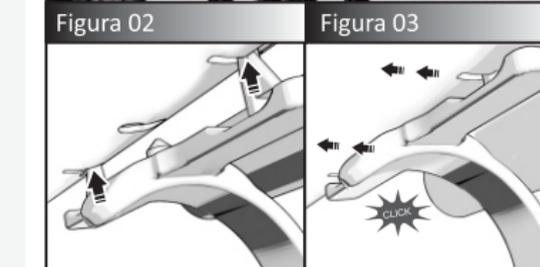
Na parte inferior do tubo central há orifícios para encaixar o suporte da garrafinha (**Figura 01**). Encaixe os pinos do suporte nos orifícios (**Figura 02**). Em seguida, deslize o suporte e ouça o "click" indicando que o mesmo está encaixado e travado corretamente (**Figura 03**).
