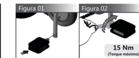
Observe que a letra "L" corresponde ao pedal a ser colocado no lado esquerdo e a letra "R" ao pedal a ser colocado no lado direito. Encaixe os pedais (**Figura 01**) e aperte utilizando a chave 15mm (não acompanha o produto) conforme indicação da (**Figura 02**).
