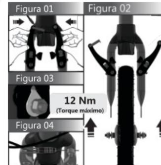
Afrouxe o freio V-Brake pressionando-o para soltar o cabo de freio (**Figura 01**). Em seguida encaixe a roda ao garfo dianteiro (**Figura 02**). Posicione a arruela de segurança no garfo, em seguida aperte a porca utilizando a chave 15mm (não acompanha o produto) (**Figura 03**). Em seguida repita o mesmo processo do outro lado. Encaixe o freio V-Brake (**Figura 04**).
