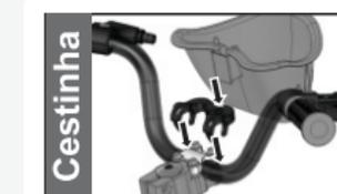
Encaixar as garras do suporte da cestinha no guidão da bicicleta. Em seguida colocar a cestinha no encaixe do suporte.
