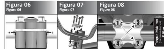
Posicionar o guidão de maneira que fique centralizado no suporte do guidão da bicicleta **(Figura 06)**. Em seguida coloque os parafusos junto a parte da tampa do suporte do guidão **(Figura 07)**. Apertar os parafusos utilizando a chave 10mm seguindo a sequência **(Figura 08)**, de forma que o aperto seja alternado seguindo um "X". Utilize a marcação no guidão para ajustar uma posição confortável para a criança.
