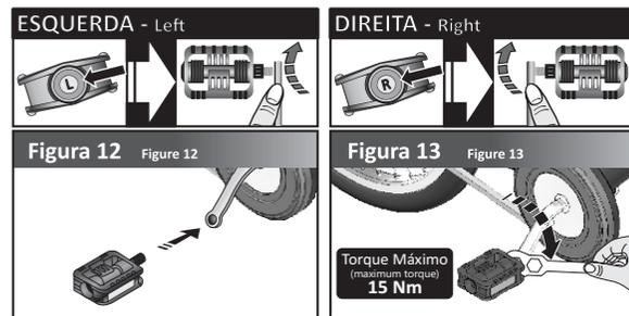
Observar que a letra "L" corresponde ao pedal a ser colocado no lado esquerdo e a letra "R" ao pedal a ser colocado no lado direito. Encaixar os pedais **(Figura 12)** e apertar utilizando a chave 15mm (não acompanha o produto) conforme indicação da **(Figura 13)**.
