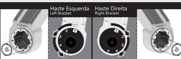
Retirar as porcas e arruelas das hastes laterais utilizando a chave 10mm (não acompanha o produto). A haste direita é limitada nas posições de 1 até 5 com sentido de giro para a direita, e a haste esquerda é limitada também nas posições de 1 até 5 porém com sentido de giro para a esquerda. As posições devem sempre ser iguais (ex: 1 com 1, 2 com 2, 3 com 3 e etc). Assim que ajustado, reapertar as porcas.
